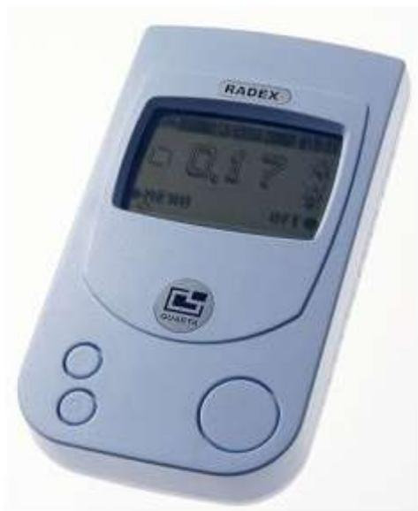
Окончание каждого промежутка времени, отмеренного таймером, сопровождается прерывистым двухтональным звуковым сигналом и зафиксированным числом на этом дисплее. Это число – число микрорентген в час. После дискретного звукового сигнала следует непрерывный короткий звуковой сигнал. Этот сигнал сопровождается цифрами на дисплее, которые соответствуют усредненному значению в мкР/ч за предыдущие временные интервалы.
