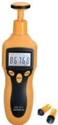
Рисунок 1 – Промышленный тахометр
