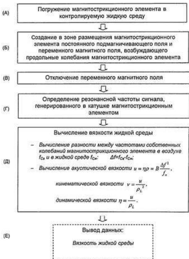
Рисунок 3 - Последовательность выполнения операций измерения вязкости.
