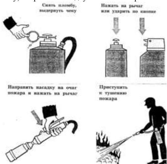
Рис.1. Приведение в действие воздушно-пенного огнетушителя.
