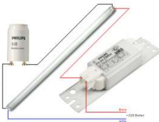
Рис. 2 - Схема люминесцентного светильника с одной лампой
