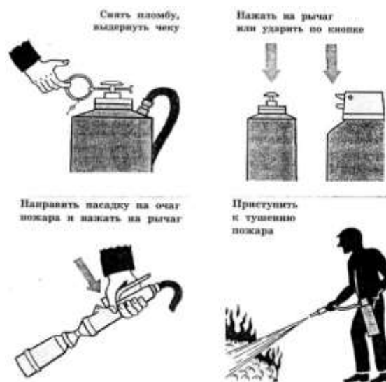
Рис.1. Приведение в действие воздушно-пенного огнетушителя.
