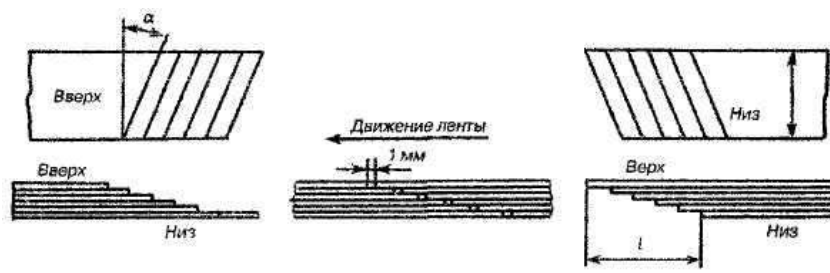
Рисунок 2.6 – Схема подготовки ленты к вулканизации
