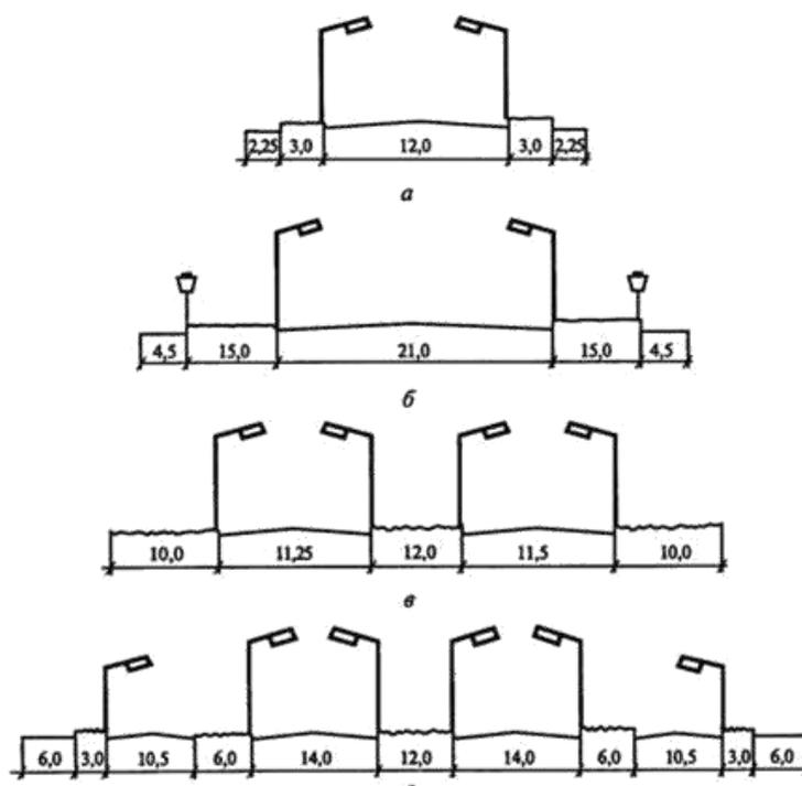
Примеры поперечных сечений улиц с разными вариантами освещения:
