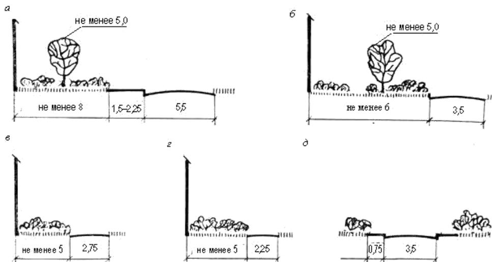
Рис. 1.3. Поперечный профиль микрорайонных проездов и дорожек: а – основной двухполосный проезд; б – кольцевой однополосный проезд; в – тупиковый однополосный проезд; г – пешеходная дорожка; д – хозяйственный проезд Площадки для стоянки автомобилей располагают на жилых улицах в местах:
