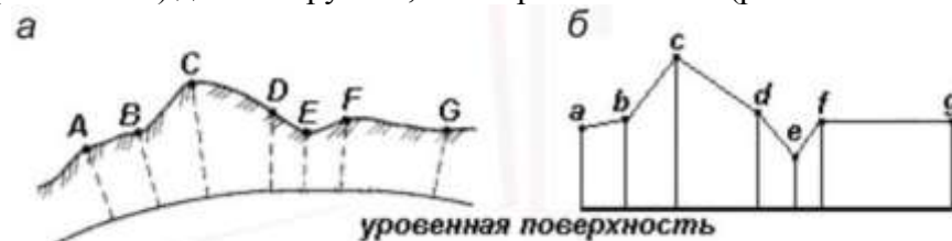
Рисунок 3.2. Вертикальный разрез (а) и профиль (б) местности
