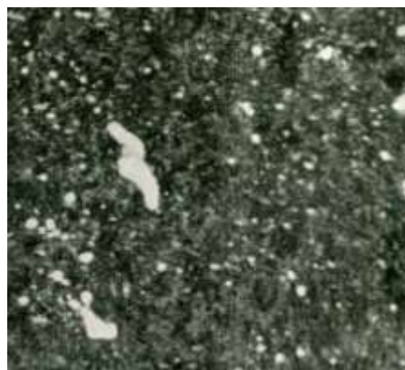
Рис.2 Микроструктура стали после заковки и многократного отпуска
