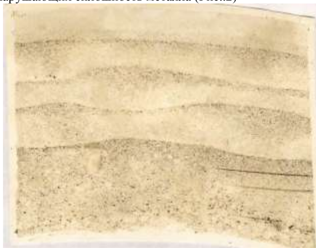
Рисунок 3 - Ликвация серы в стали
