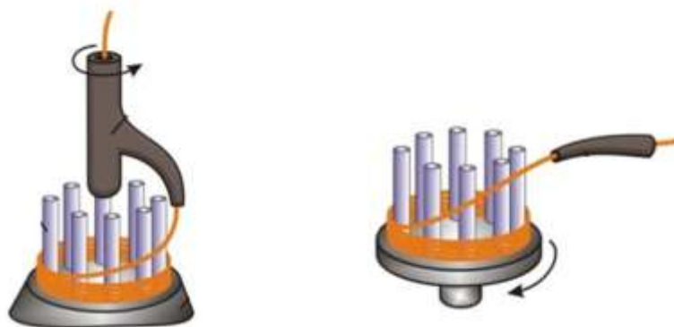
Рисунок 10 - Мелкосортные (проволочные) моталки с бунтом:
