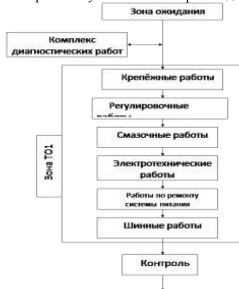
Рисунок - Схема организации технологического процесса зоны ТО-1
