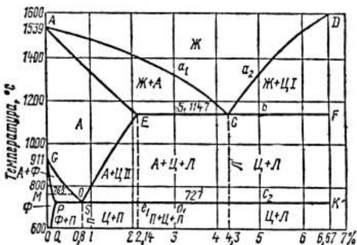
чугуна) и превращения в их структурах при медленном охлаждении от жидкого расплава до комнатной температуры (рис. 9).
