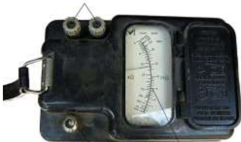
Рис. 9.8. Внешний вид мегомметра М1101М: 1 – зажимы «Линия» и «Земля»; 2 – переключатель «кОм/МОм»; 3 – измерительная шкала
