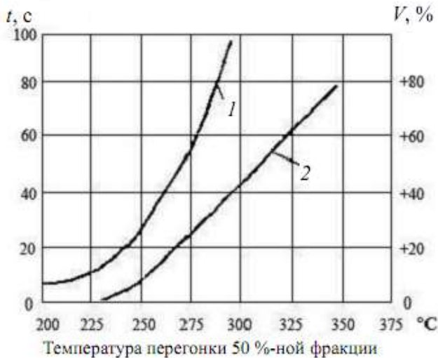
Рис. 6. График для определения пусковых качеств и расхода дизельного топлива: 1 – время проворачивания двигателя; 2 – расход топлива
