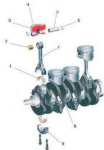
Схема КШМ: 1 - вкладыш шатунного подшипника; 2 - ступля задний провала шатуна; 3 - поршневые кольца; 4 - поршень;
