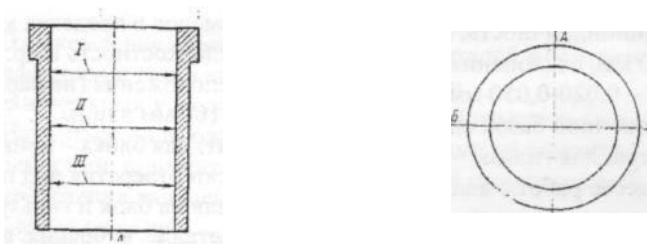
Рис. 1. Схема обмера отверстия под поршень в гильзе цилиндра
