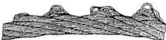
Рис. 14. Выдавливание проволок прядей: а - в одной пряди; б - в нескольких прядях
