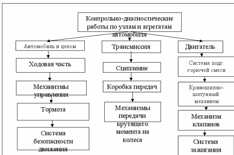
Система контрольно-диагностических работ при техническом обслуживании подъемно-транспортных, строительных, дорожных машин и оборудования
