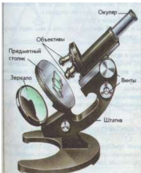
Рис. 1. Строение светового микроскопа
