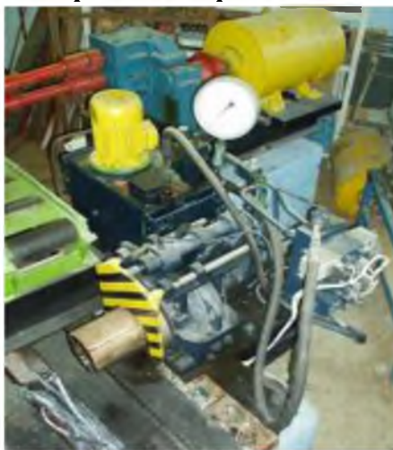
Рисунок 15 - Общий вид гидропривода моталки и сталкивателя рулонов
