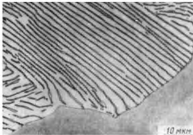
Рисунок 3 – Строение перлита около границы колонии
