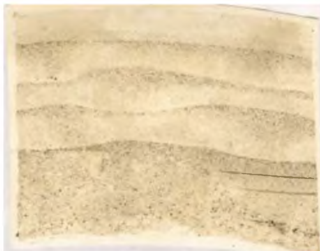
Рисунок 1 - Ликвация серы в стали
