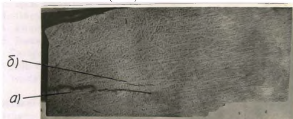
Рисунок 2 - Дефекты, нарушающие сплошность металла а) трещина; б) флокены
