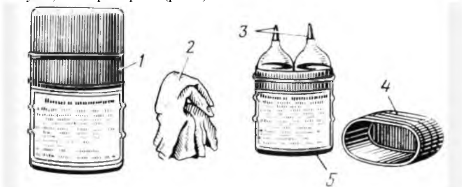
Рис. 4. Индивидуальный противохимический пакет ИПП-8 (1 – жестяной футляр; 2 – бумажные салфетки; 3 – стеклянные ампулы; 4 – крышка; 5 – памятка по пользованию пакетом)
