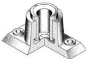
подшипник скольжения, в корпус (1) которого устанавливается сначала вкладыш (2), а затем пята (цанга — конец вала), опирающийся на плоский выступ нижней части корпуса.
