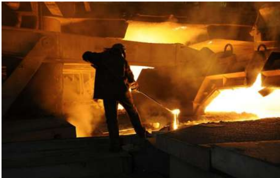
Рис. 5.4. Выполнение горновых работ
