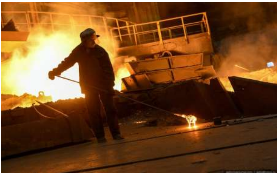
Рис.5.6. Отбор пробы чугуна
