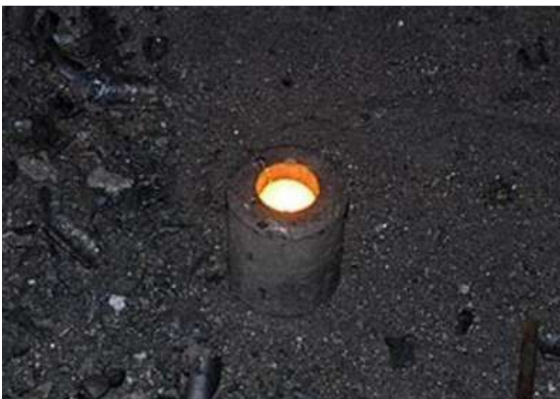
Рис. 5.5 - Изложница для проб чугуна
