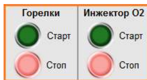
Рисунок 3. Панель управления стеновых газокислородных горелок и кислородныхинжекторов
