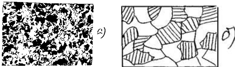
Рис. 2. Микроструктура (а) и ее схема (б) стали 30ХГСА после отжига
