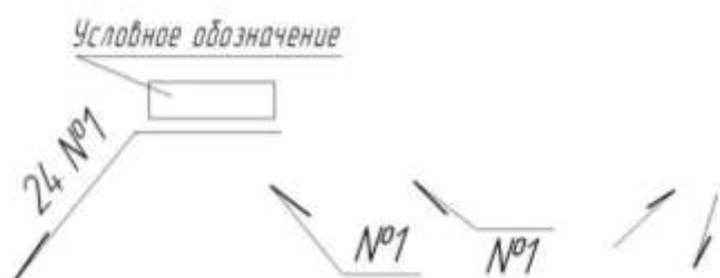
Рисунок 102 – Условные обозначения при наличии на чертеже одинаковых швов: а) у одного изображения; б) у остальных изображений; в) упрощенное или все швы на чертеже одинаковые
