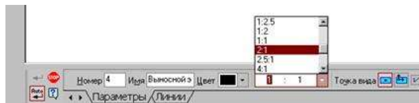
Рис.47 Выбор масштаба отображения выносного элемента
