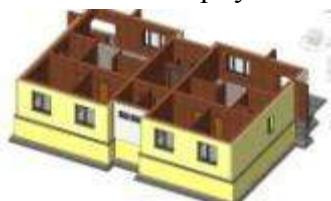
Рис. 7. Модель со скрытым внешним слоем кирпичной кладки
