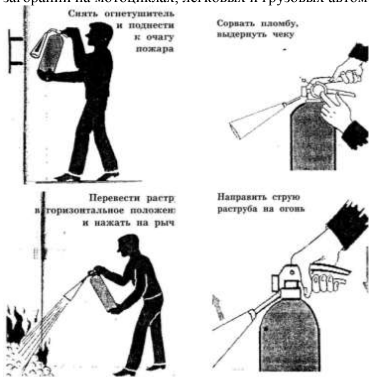
Рис. 3. Приведение в действие ручного углекислого огнетушителя.
