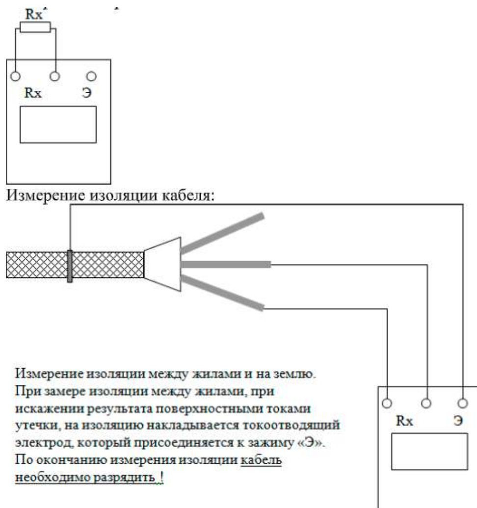
Рисунок 1 - Схема проверки изоляции мегомметром. Измерение сопротивления
