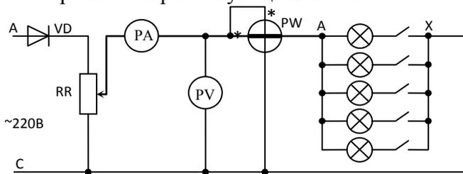
4. Провести опыты: установить с помощью реостата напряжение в цепи нагрузки 80В. Поочередно включая лампы накаливания записать показания приборов.
