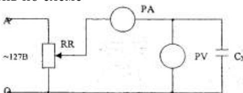
3. Провести опыт. Установить с помощью реостата напряжение питания цепи 60В, записать значение силы тока и напряжения в таблицу
