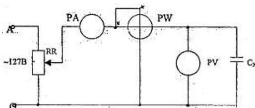
6. Провести опыт. Установить с помощью реостата напряжение питания цепи 115 В, записать значение силы тока, напряжения, активной мощности в таблицу
