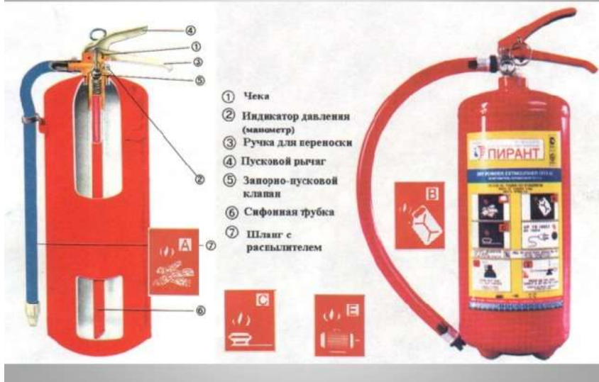
рис.3 порошковый огнетушитель
