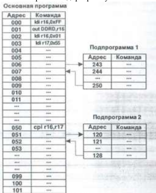
Рис. 1. Принцип работы указателя стека
