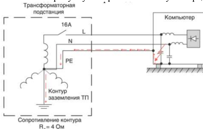
Рисунок 1 - Система заземления СВТ
