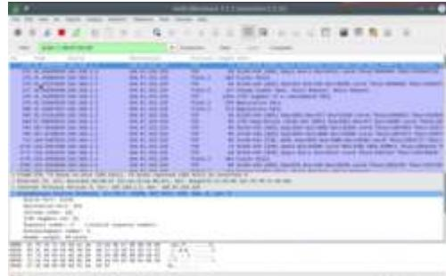
А чтобы получить не только отправленные пакеты, но и полученные в ответ от этого узла, можно объединить два условия: `ip.dst == 194.67.215.125 || ip.src == 194.67.215.125`
