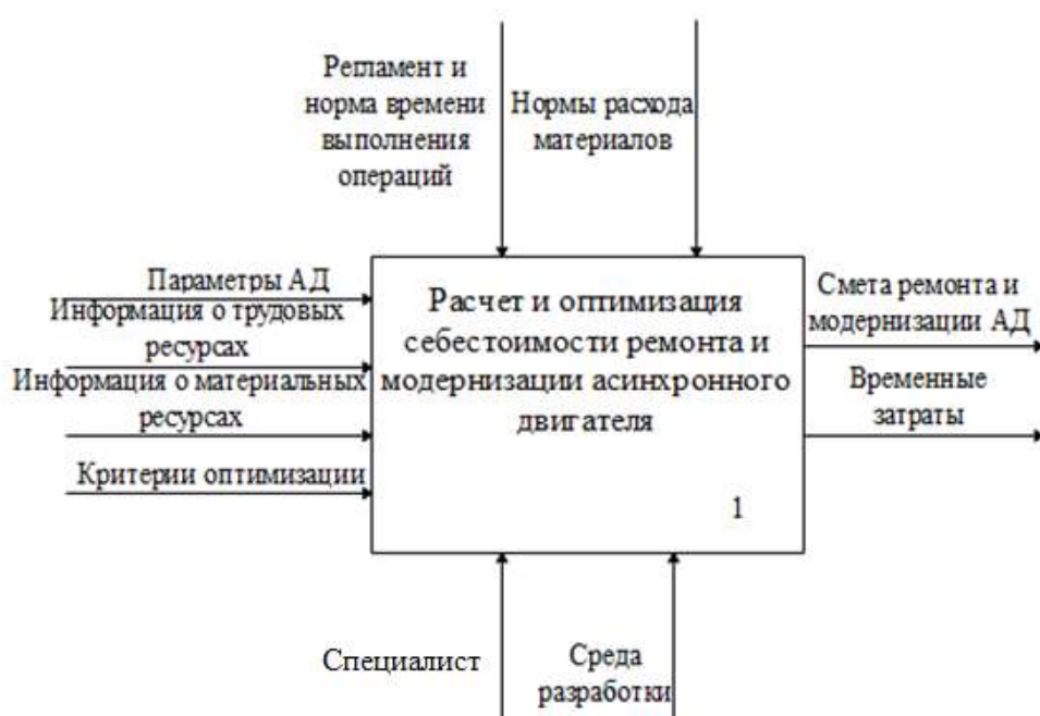
Рисунок 1 – Функциональная модель бизнес-процесса расчета и оптимизации себестоимости ремонта и модернизации асинхронного двигателя
