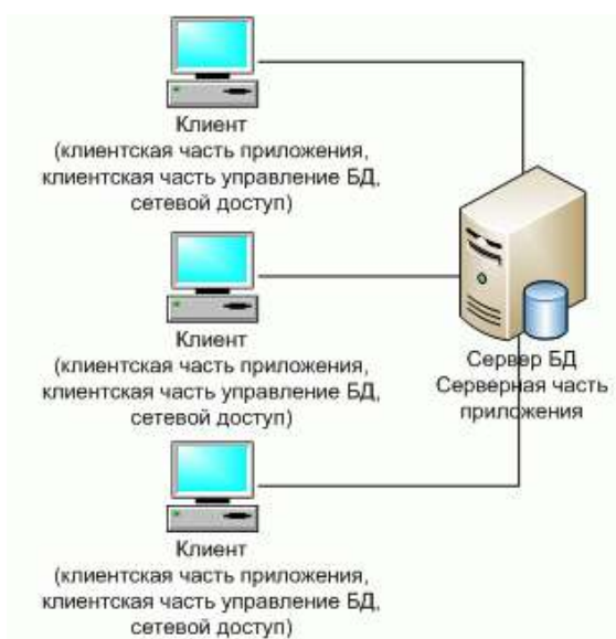
Рис. 3. Классическое представление архитектуры "клиент-сервер"
