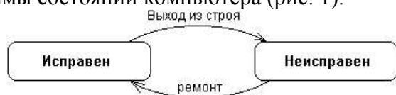
Рис. 1. Простейший пример диаграммы состояний для технического устройства типа компьютер
