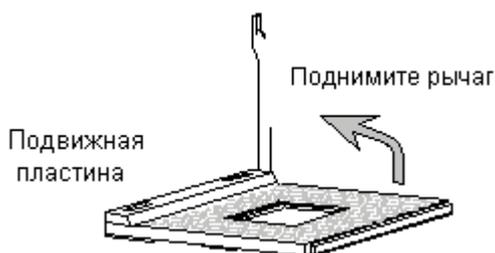
2. Обратите внимание на скошенный угол на процессоре. Он указывает на основание рычага. Процессор войдет в разъем только при правильном его расположении.
