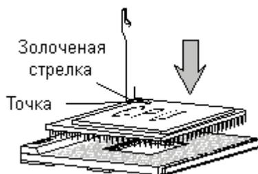
3. Опустите процессор в разъем до упора и затем опустите рычаг. Установка процессора на этом закончена.
