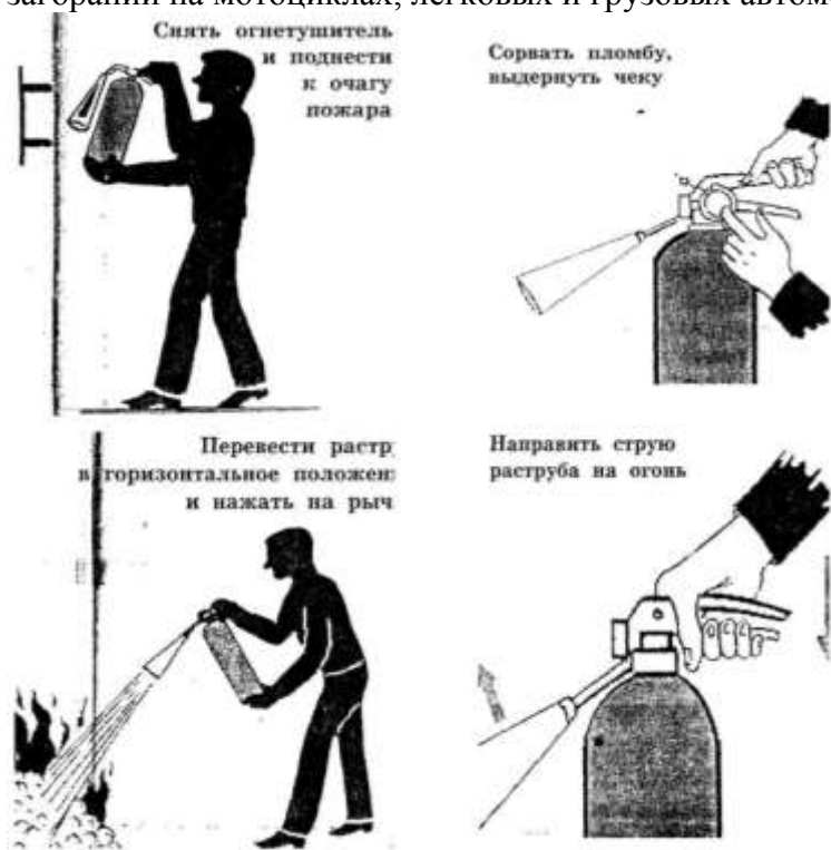
Рис. 3. Приведение в действие ручного углекислого огнетушителя.
