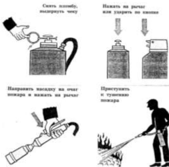
Рис.1. Приведение в действие воздушно-пенного огнетушителя.
