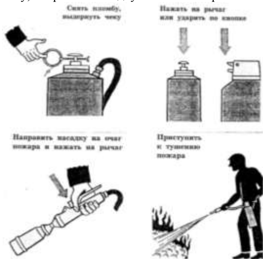
Рис.1. Приведение в действие воздушно-пенного огнетушителя.
