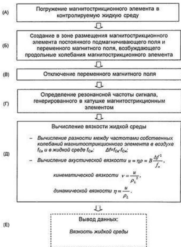
Рисунок 3 - Последовательность выполнения операций измерения вязкости.
