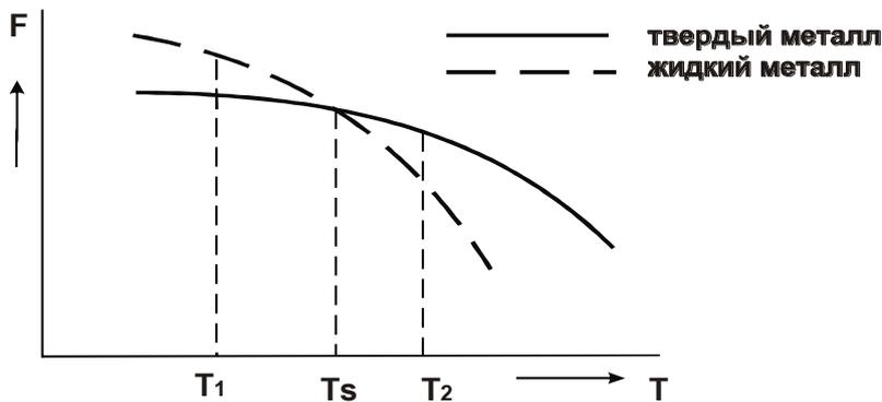
Рис. 2. Зависимости свободной энергии металла от температуры
