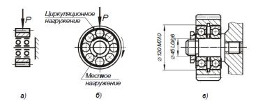
**Третья типовая схема**. Внутренние кольца подшипников вращаются вместе с валом, наружные кольца, установленные в корпусе, — неподвижны. На кольца действуют две радиальные нагрузки, одна постоянна по величине и по направлению P, другая, центробежная, вращающаяся вместе с валом.
