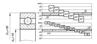
Из схемы видно, что поля допусков для внутреннего и наружного колец подшипника качения расположены одинаково относительно нулевой линии, верхнее отклонение равно 0, нижнее — отрицательное.
