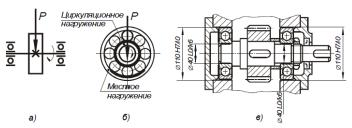
**Вторая типовая схема**. Наружные кольца подшипников вращаются вместе с зубчатым колесом. Внутренние кольца подшипников, посаженные на ось, остаются неподвижными относительно корпуса. Радиальная нагрузка P постоянна по величине и не меняет своего положения относительно корпуса.
