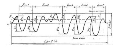
Для обработки профилограммы задаются значения базовой длины  $\ell=2,5$  мм и уровня сечения профиля p=25%. Параметры шероховатости, полученные по профилограмме, сравнить с заданными
