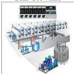
Циркуляционные системы применяются там, где помимо непосредственного смазывания работающих узлов и механизмов необходимо дополнительное охлаждение. Такие системы должны обладать способностью подавать нужное количество высококачественного масла в каждую точку смазывания. Кроме того, работать в условиях высоких температур и обладать способностью очищать масло от абразивных частиц, продуктов окисления, воды и пузырьков воздуха.
