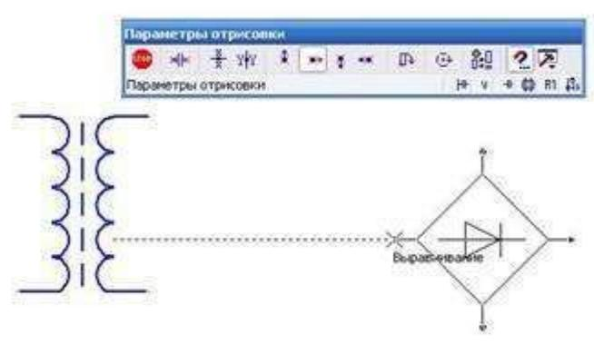
диодный мост, нам нужно соединить его с трансформатором, для этого с левой стороны программы нажимаем на символ ГЕОМЕТРИЯ (кружочек с треугольником), находится на самом верху, и ниже выбираем символ ОТРЕЗОК. Соединяем от точки к точке:
