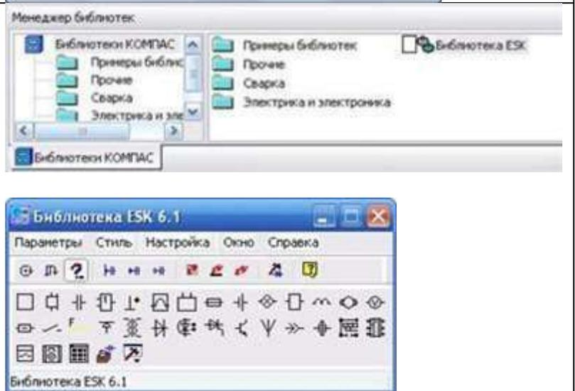
начнем с трансформатора, в библиотеке выбираем нужный нам элемент, а именно трансформатор (магнитоэлектрический), далее кликаем появившимся символом на лист, чтобы закрепить его. Масштабировать (увеличивать или уменьшать размер) лист можно колесиком мышки, отменить действие можно кнопкой ESC на клавиатуре. Чтобы удалить закрепленный элемент с листа, просто кликаем на него и нажимаем на клавиатуре кнопку Delete.
