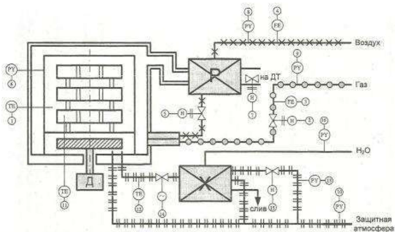
Рис.1. Функциональная схема контроля и регулирования процесса отжига металла в колпаковой печи.
