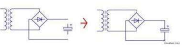
После того как закрепили конденсатор, и соединили все элементы между собой линиями, можно нарисовать соединители, а к трансформатору, последовательно одной из первичных обмоток, можно нарисовать предохранитель, а после соединительную вилку.
