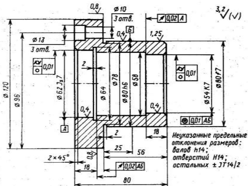
Рисунок 1 - Деталь — фланец
