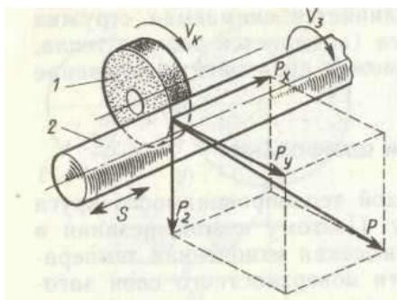
Рисунок 6 - Схема сил резания при шлифовании
