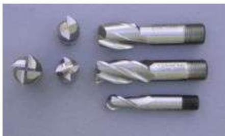
Рисунок 1- концевые фрезы.
