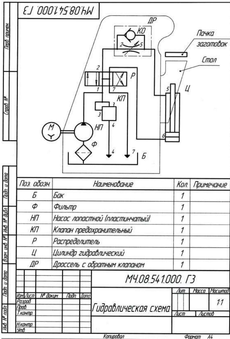
Рисунок 4 - Условные графические обозначения основных элементов гидропривода
