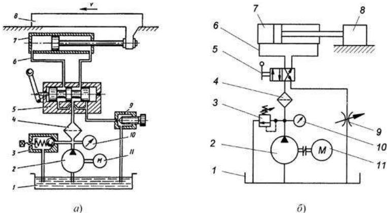
Рисунок 1 - Полуконструктивное (а) и схематическое (б) изображение гидропривода
