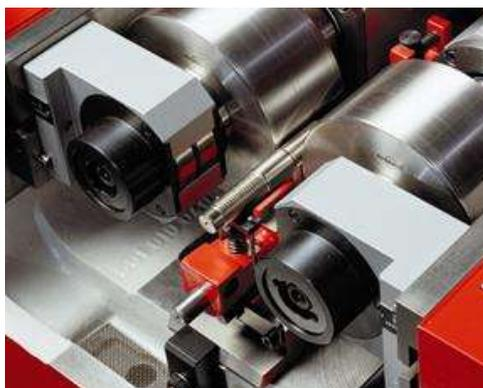
Рисунок 6 - Резьбонакатный станок
