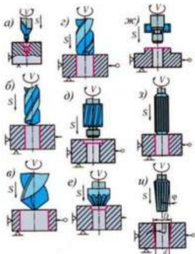
Рисунок 1 – Обработка отверстий на вертикально-сверлильном станке
