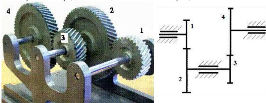
Рисунок 1 - Двухступенчатая зубчатая передача и ее кинематическая схема
