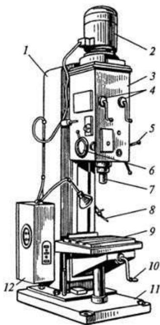
1 — колонна (станина); 2 — двигатель; 3 — сверлильная головка; 4 — рукоятки переключения коробок скоростей и подач; 5 — штурвал ручной подачи; 6 — лимб контроля глубины обработки; 7 — шпиндель; 8 — сопло охлаждения; 9 — стол; 10 — рукоятка подъема стола; 11 — фундаментная плита; 12 — шкаф электрооборудования
