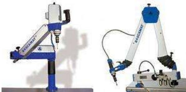
Рисунок 11 - Резьбонарезные станки-манипуляторы
