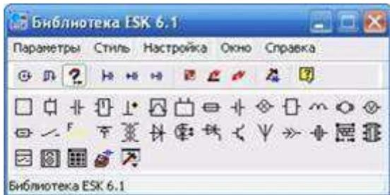
начнем с трансформатора, в библиотеке выбираем нужный нам элемент, а именно трансформатор (магнитоэлектрический), далее кликаем появившимся символом на лист, чтобы закрепить его. Масштабировать (увеличивать или уменьшать размер) лист можно колесиком мышки, отменить действие можно кнопкой ESC на клавиатуре. Чтобы удалить закрепленный элемент с листа, просто кликаем на него и нажимаем на клавиатуре кнопку Delete.
