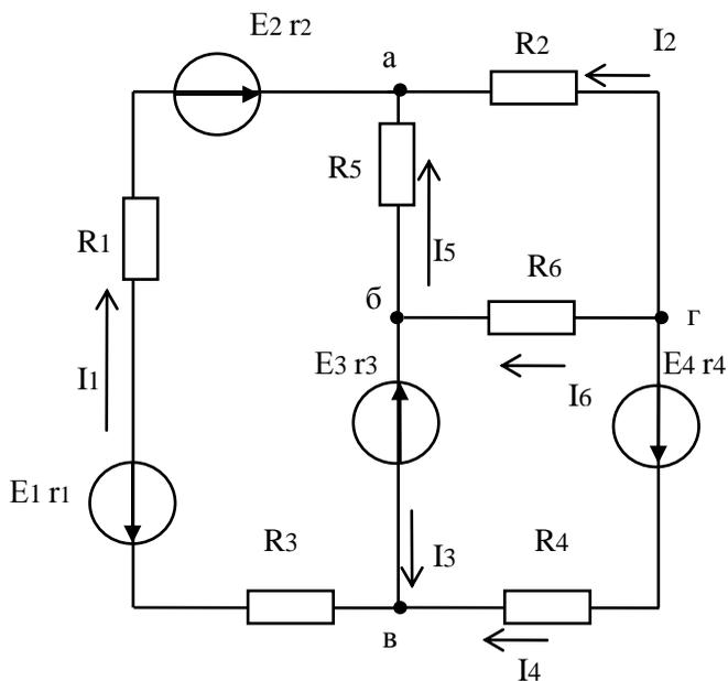
A)  $-E_1 \cdot I_1 + E_2 \cdot I_1 - E_3 \cdot I_3 - E_4 \cdot I_4 = I_1^2 (R_3 + r_1 + R_1 + r_2) + I_2^2 R_2 + I_3^2 r_3 + I_4^2 (R_4 + r_4) + I_5^2 R_5 + I_6^2 R_6$
