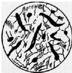
Рис. 8 Структура заэвтектического чугуна
