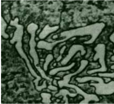
Рис.2 Микроструктура стали после отжига
