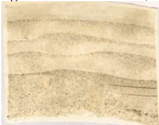
Рис. 1. Ликвация серы в стали
