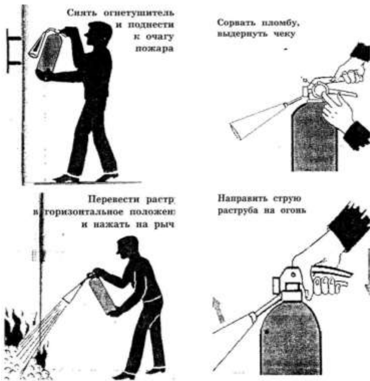
Рис. 3. Приведение в действие ручного углекислого огнетушителя.
